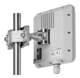
Este dispositivo brinda una solucion punto a punto la cual esta diseñada para una conectividad confiable y disponible en bandas de frecuencia con licencia y sin licencia, aportando un rendimiento neto de hasta 34 Mbps por estación base Sector y distancias operativas superiores a 25 km. A continuacion, se relacionan algunas de las caracteristicas tecnicas de este dispositivo.
